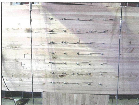
写真 5-67 試験体名：T75-1 回転による木材の圧縮めり込み 及び、引張割裂(南面) 状況
