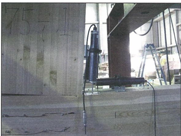
写真 5-69 試験体名：T75-1 回転による木材の圧縮めり込み 及び、引張割裂(南面) 状況
