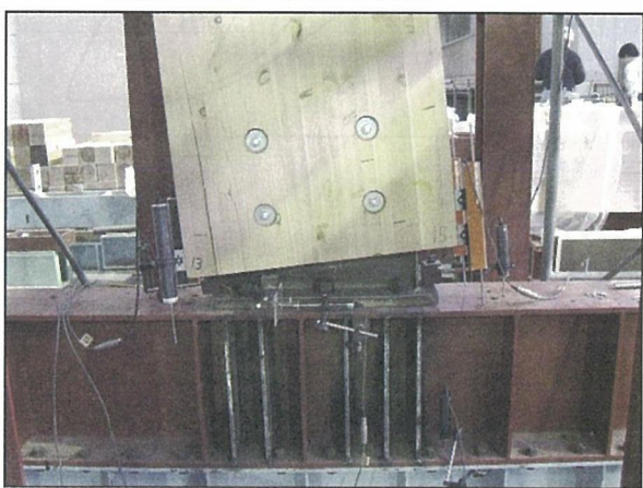
写真 5-30 試験体名 : 175-1 高力ボルトの伸び・H鋼のフランジ部分から木材の割裂状況
