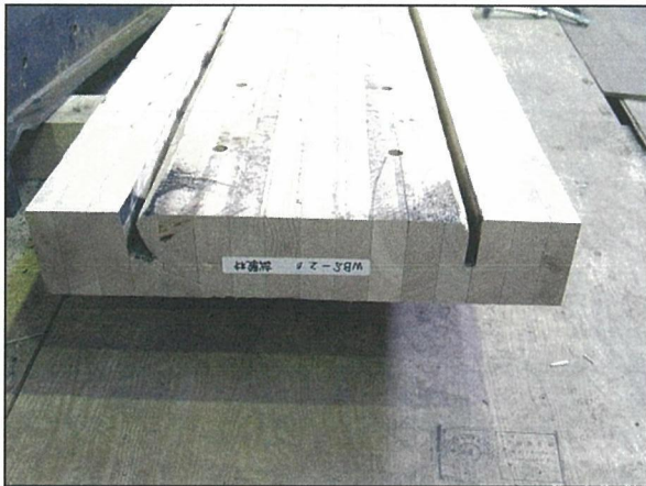
写真 5-15 試験体名：I55-1-3（解体後） 圧縮側のH鋼フランジの局部 座屈による木材の亀裂状況
