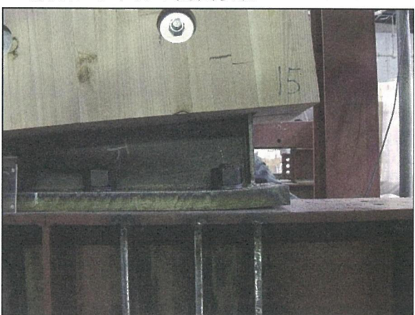
写真 5-32 試験体名 : 175-1 H鋼のベース板の曲がり 高力ボルトの伸び状況
