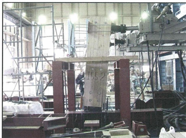
写真 5-17 試験体名：I55-2 回転によるH鋼の破壊 H鋼のベース板の曲がり状況
