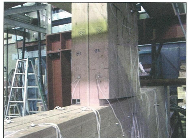
写真 5-84 試験体名：T75-3 回転による木材の圧縮めり込み 及び、引張割裂（南面）状況
