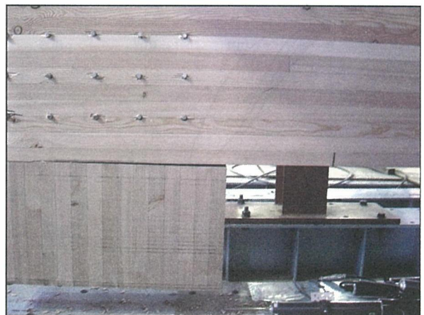
写真 5-78 試験体名：T75-2 ドリフトピン部分からの割裂状況
