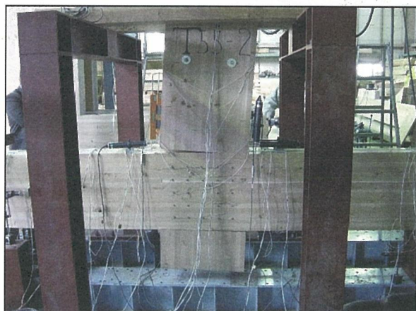
写真 5-58 試験体名：T55-2 梁-柱接合部の回転破壊(南面)状況
