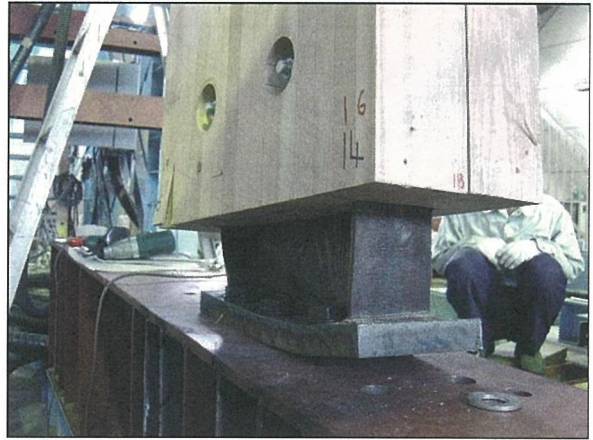
写真 5-14 試験体名：I55-1-3 H鋼のベース板の曲がり・高力ボルトの 伸び・圧縮側のH鋼フランジの局部 座屈による木材の割裂状況
