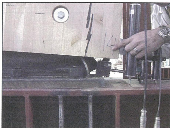
写真 5-28 試験体名 : 175-1 H鋼のベース板の曲がり 高力ボルトの伸び状況
