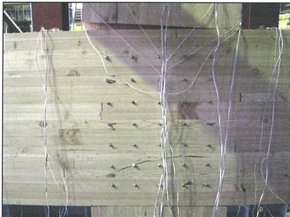
写真 5-83 試験体名：T75-3 回転による木材の圧縮めり込み 及び、引張割裂（南面）状況
