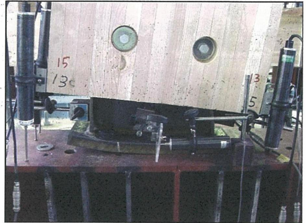
写真 5-10 試験体名：I55-1-3 H鋼のベース板の曲がり・高力ボルト の伸び状況
