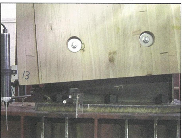
写真 5-31 試験体名 : 175-1 引張側のH鋼フランジの伸び・圧縮側のH鋼フランジの局部座屈状況
