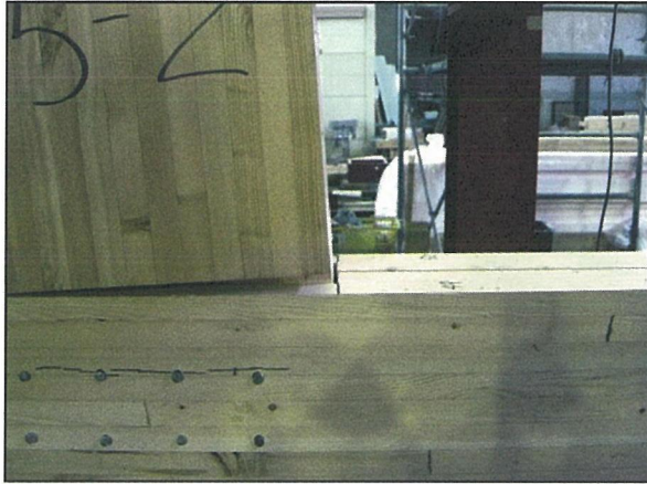
写真 5-79 試験体名 : T75-2 回転による木材の圧縮めり込み 及び、引張割裂（北面）状況
