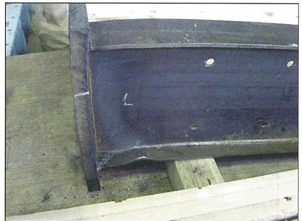
写真 5-16 試験体名：I55-1-3（解体後） ウェブの局部座屈
