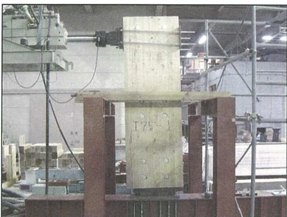
写真 5-29 試験体名 : 175-1 回転によるH鋼の破壊 H鋼のベース板の曲がり状況
