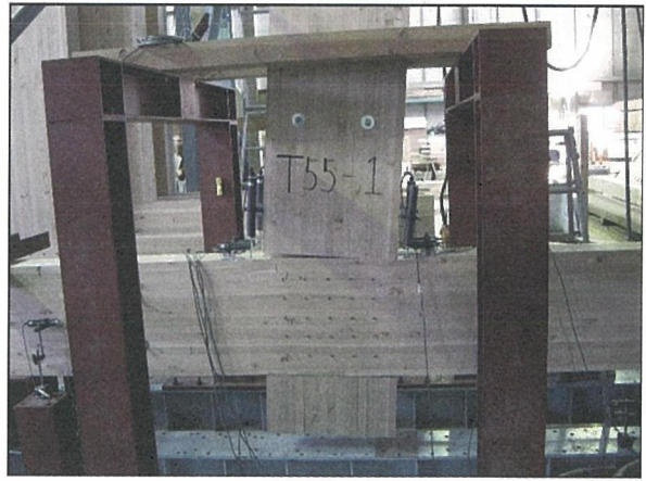
写真 5-50 試験体名：T55-1 梁-柱接合部の回転破壊(南面)状況
