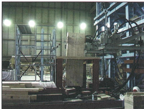
写真 5-25 試験体名 : I75-1 回転によるH鋼の破壊 H鋼のベース板の曲がり状況
