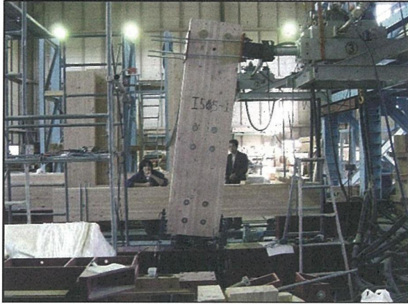
写真 5-9 試験体名：I55-1-3 回転によるH鋼の破壊状況
