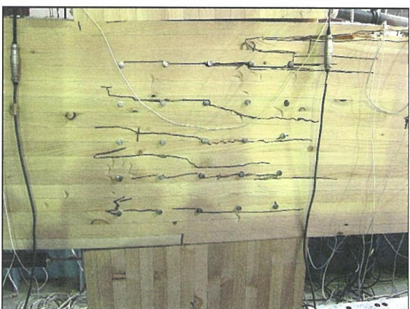
写真 5-62 試験体名：T55-2 ドリフトピン部分からの割裂状況
