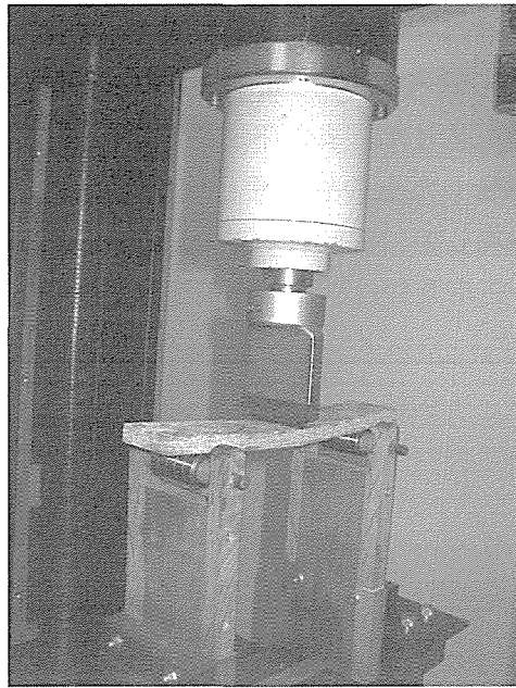
写真 8 曲げ強度試験
