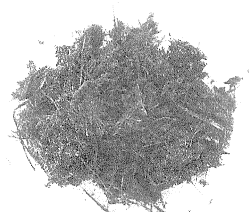
写真9. 木質ペレット原料として粉碎された広葉樹樹皮
