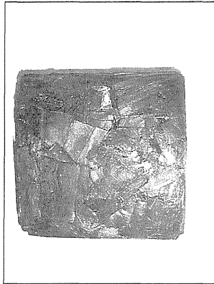
写真 8 ランダム積層した過酸化水素水処理樹皮からの平板状成形体
