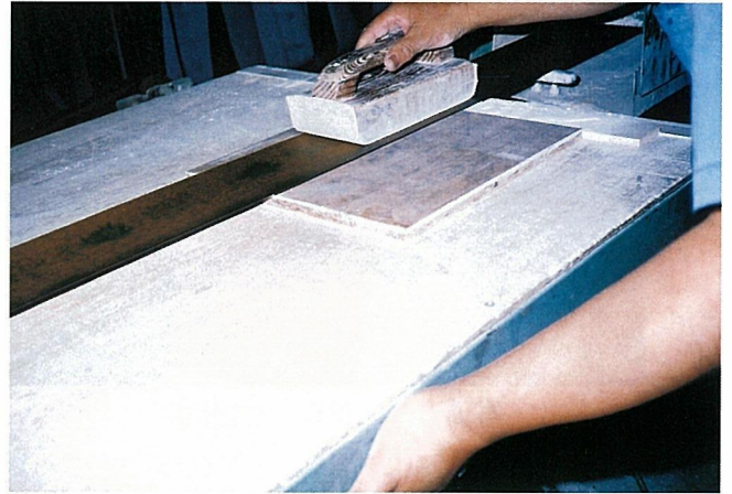
写真3 ベルトサンダーによる研磨
