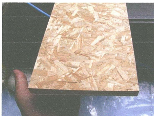
写真 スtrandボード外観
