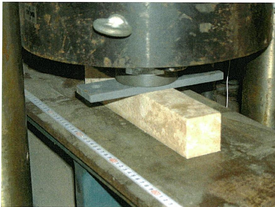
写真6 部分圧縮試験
