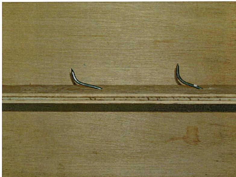
写真 13 木 60%複合材料の一面せん断試験における釘の引抜け
