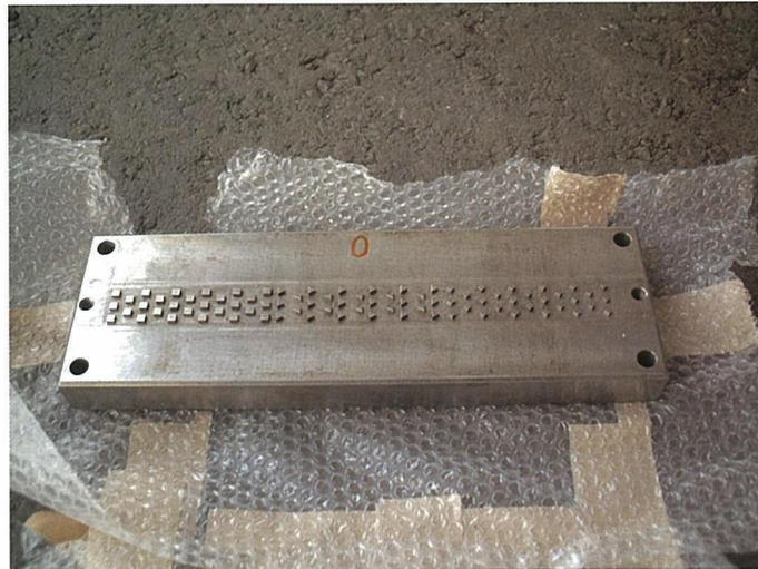
写真 13 修正後のエンボス加工用下部金型
