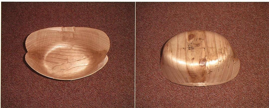
写真 24 幅の狭い単板を用いて製造した木質トレイ（切り欠き）
