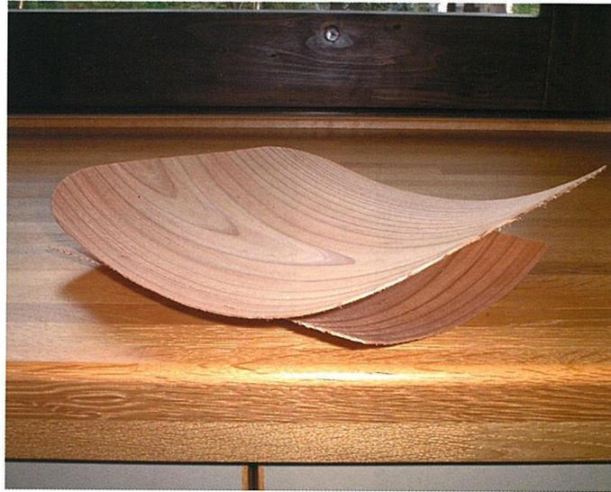
写真 20 乾燥により変形した単板
