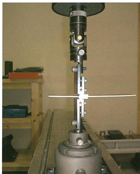
写真6 板厚方向引張試験状況
