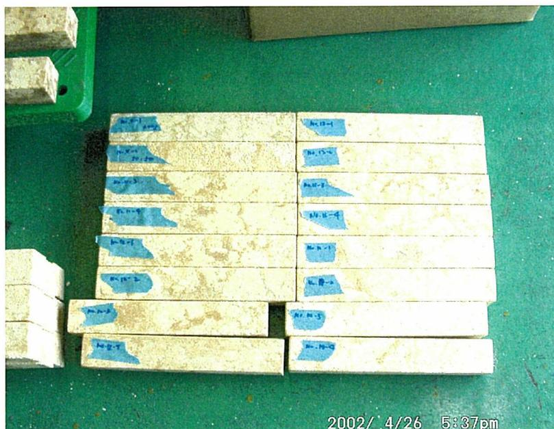
写真3 柱状試験体例
