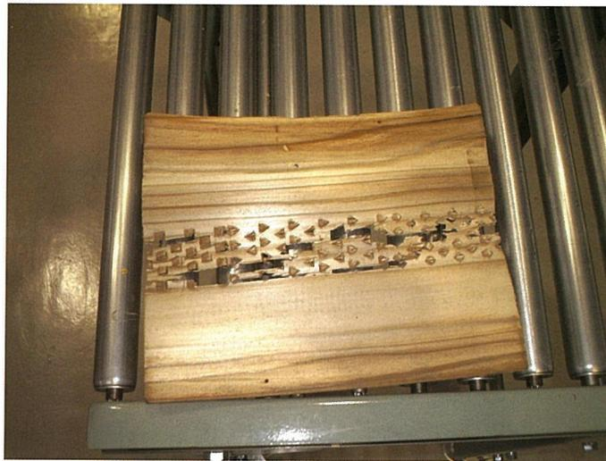
写真 11 エンボス試験を行った単板のパンク損傷
