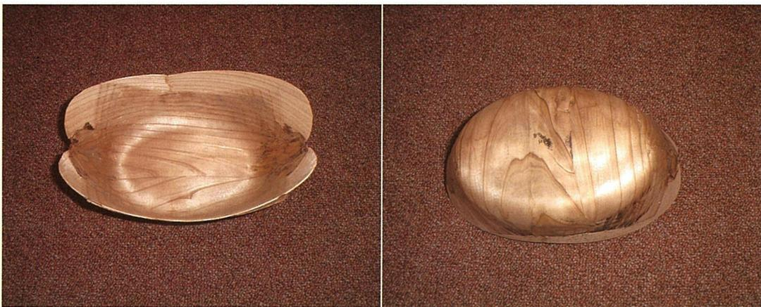
写真 23 幅の狭い単板を用いて製造した木質トレイ（重ね合わせ）
