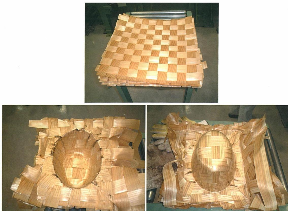
写真 25 単板の編み込みにより製造した木質トレイ（単板幅 40mm）
