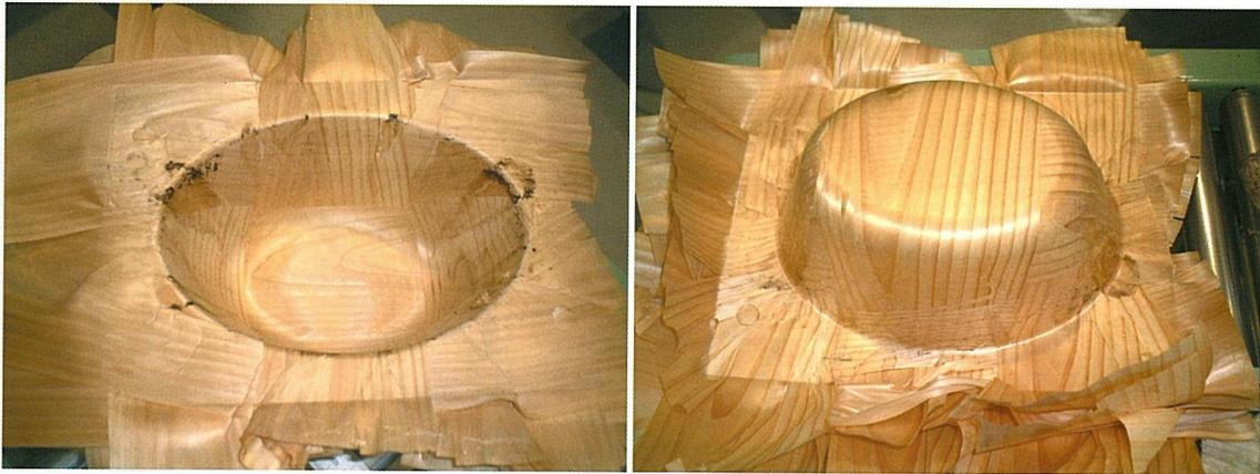
写真 26 単板の編み込みにより製造した木質トレイ（単板幅 115mm）
