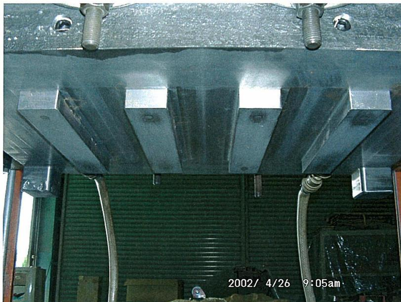
写真 4 柱状試験体用の金型上面
