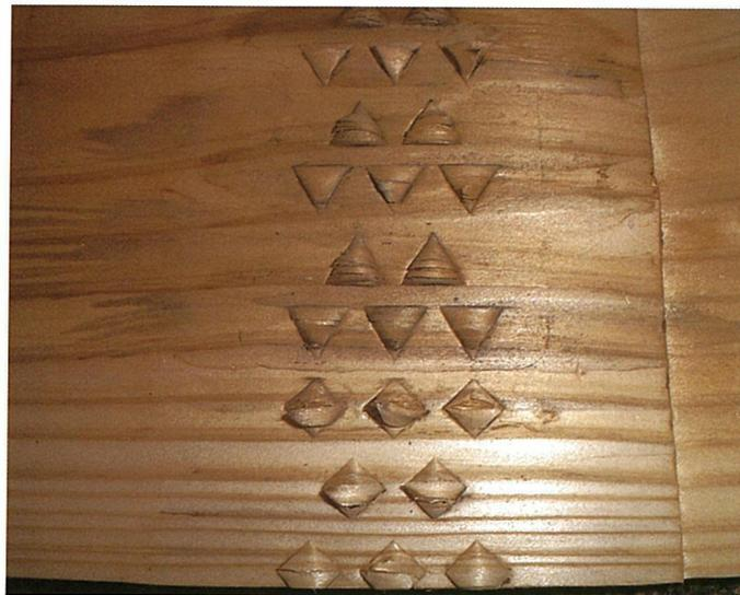
写真 12 エンボス試験を行った単板の損傷
