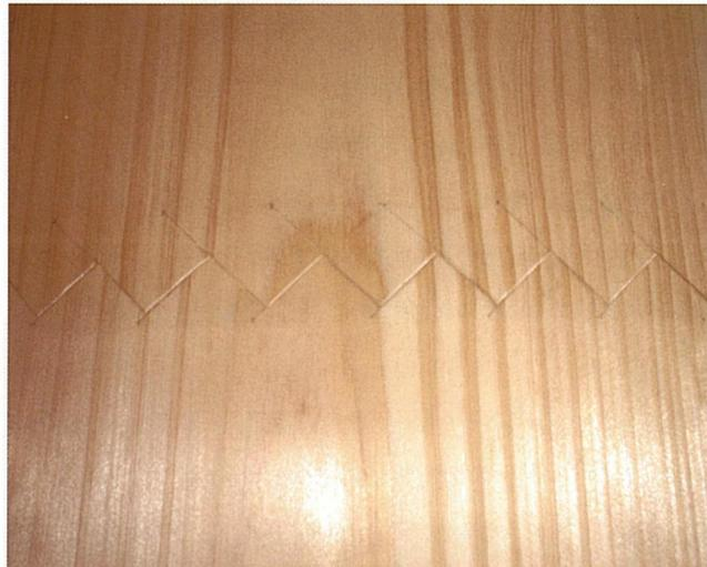
写真7 斜め欠き込みによる単板の組み合わせ
