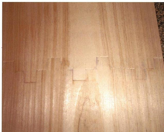
写真8 欠き込みの応用による単板の組み合わせ
