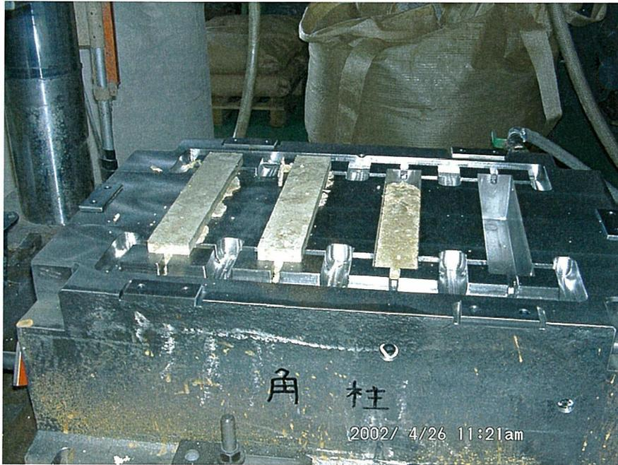
写真5 柱状試験体製造過程
