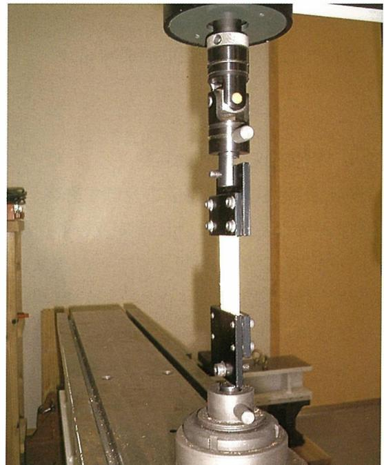
写真5 引張せん断試験状況
