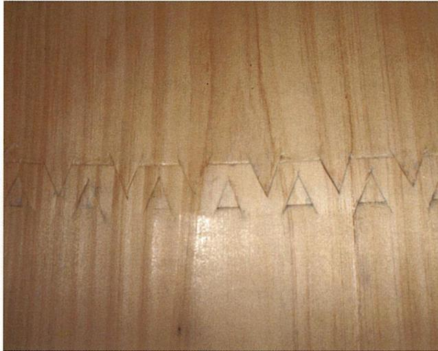
写真9 斜め欠き込みの応用による単板の組み合わせ
