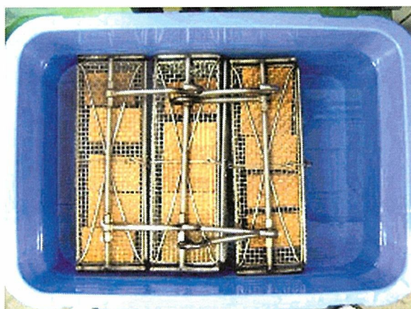
写真5 塗装集成材の浸せきはくり試験(20 サイクル)
