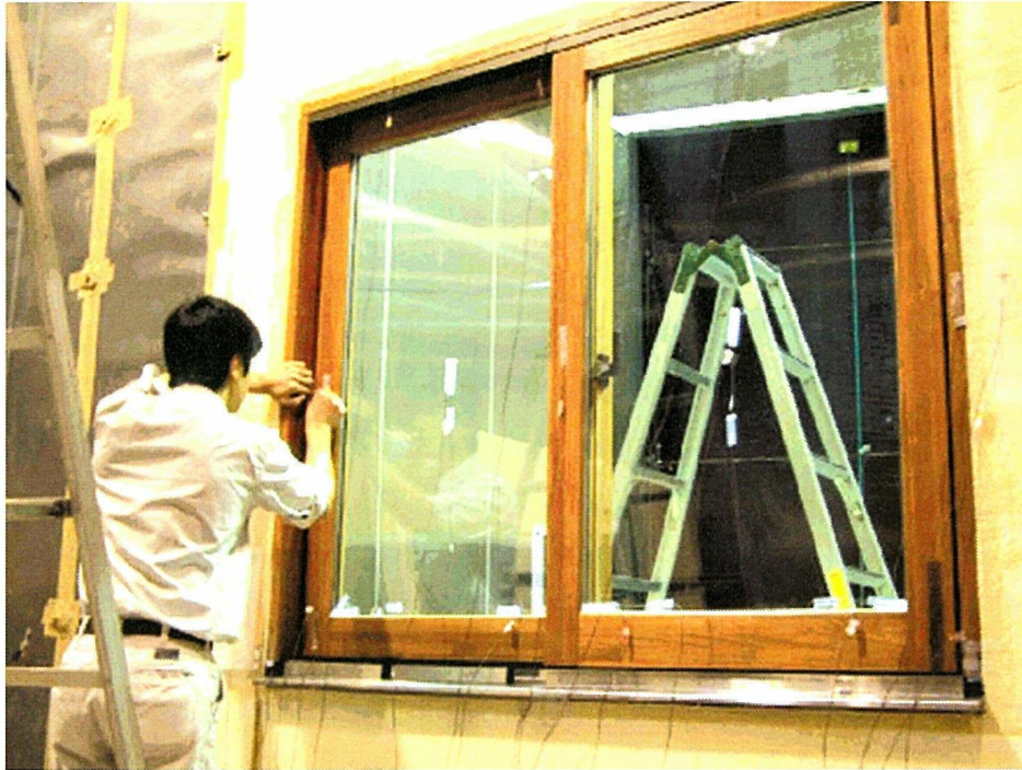
写真 15 断熱性試験での温度センサのセッティング
