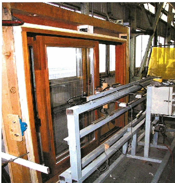
写真 13 開閉繰り返し試験中のスギ集成材製引違い戸型サッシ
