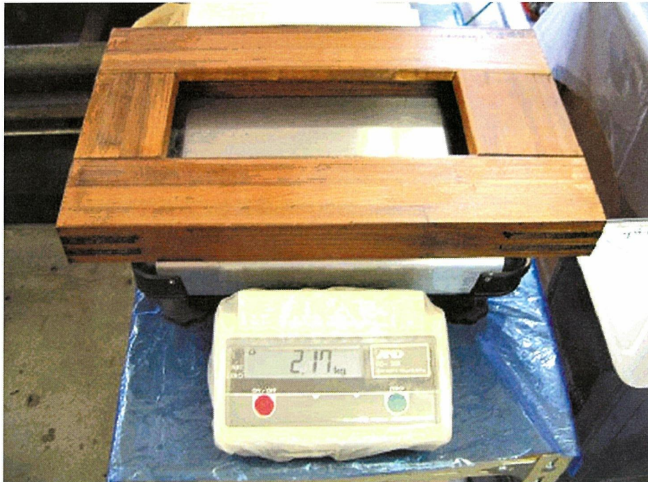
写真7 室温水浸せき(上)と含水率測定(下)の塗装障子
