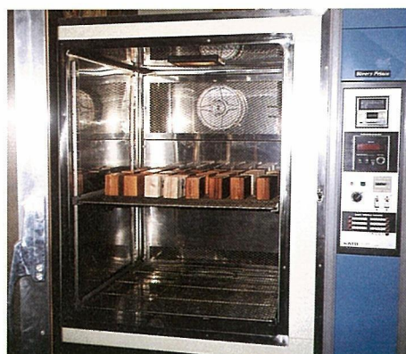
写真5 塗装集成材の浸せきはくり試験(20 サイクル)
