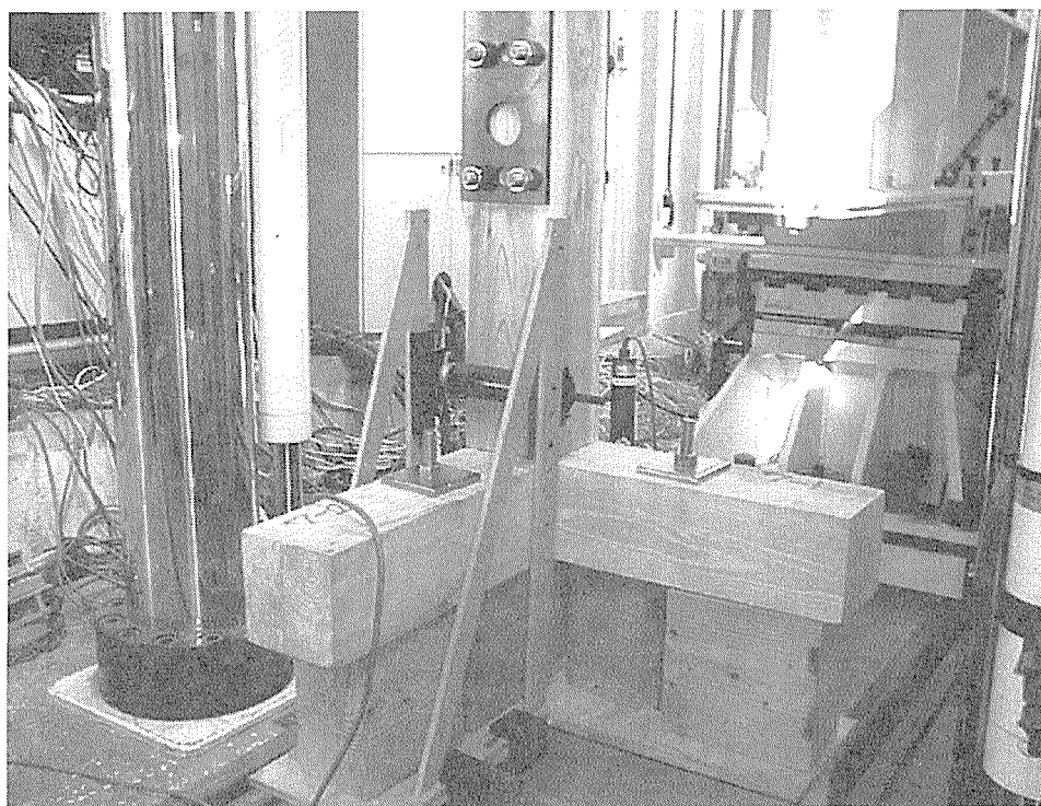
写真3-2 大入れ長ほぞ差し試験状況 直交する2カ所で土台を固定
