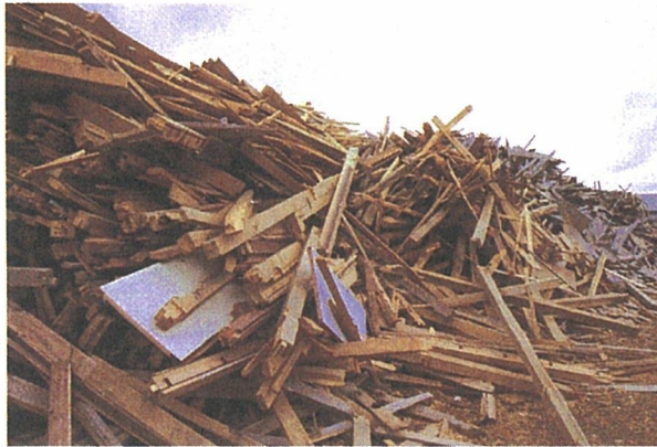
解体直後の変色のない解体木材
