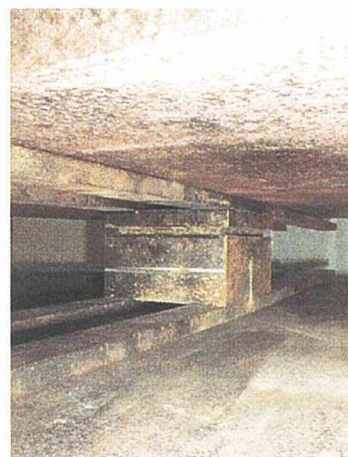
写真5 ホットプレスへセットしたモールド
