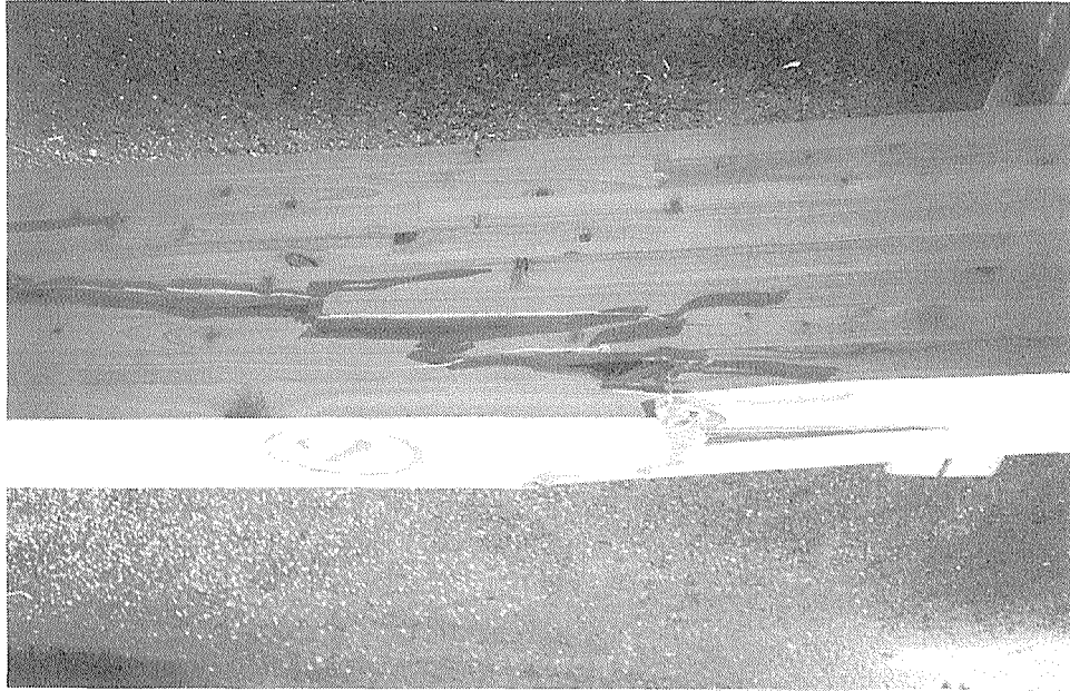
写真 16 破壊形態:ヒノキ平使い最外層再割ラミナ使用
