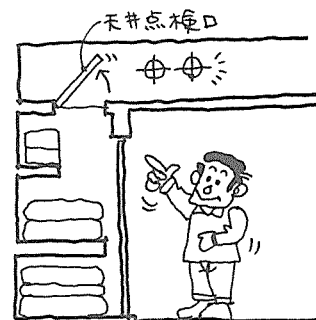
天井内横引き配管のための点検口
