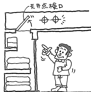
天井内横引き配管のための点検口
