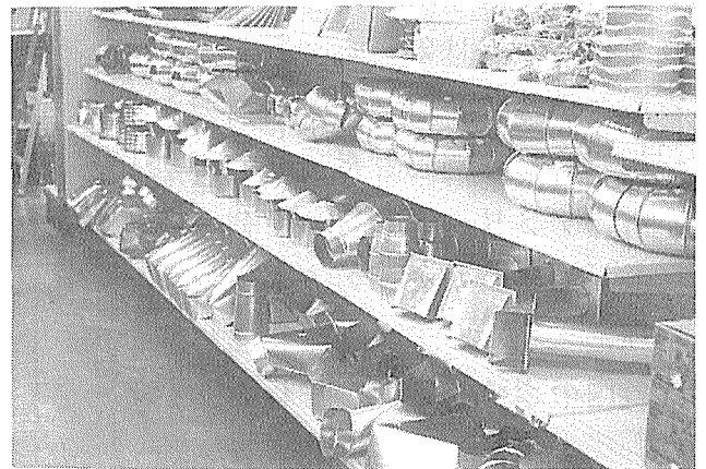
加工されたダクト用板金類
