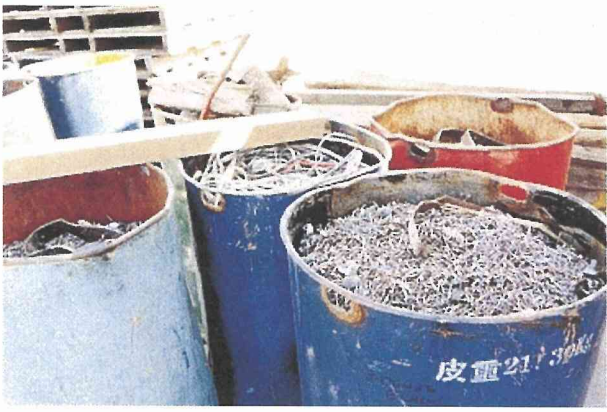
《調査写真 1.5》 破碎工程で除去された釘など
