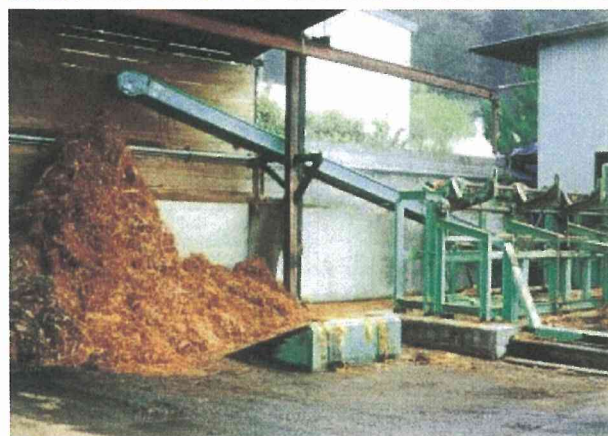
《調査写真 4.2》 リングバーカーから排出された樹皮
