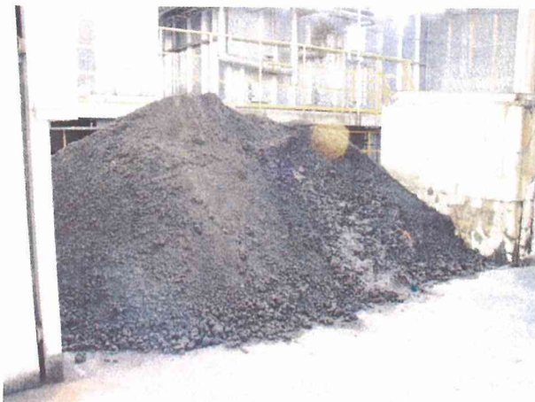
《調査写真 9.4》 木屑炊きボイラーから排出された灰
