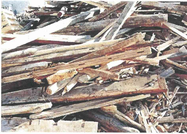
【株式会社 ヤマゲン】 《調査写真 1.1》 チップの原料となる解体材(拡大)
