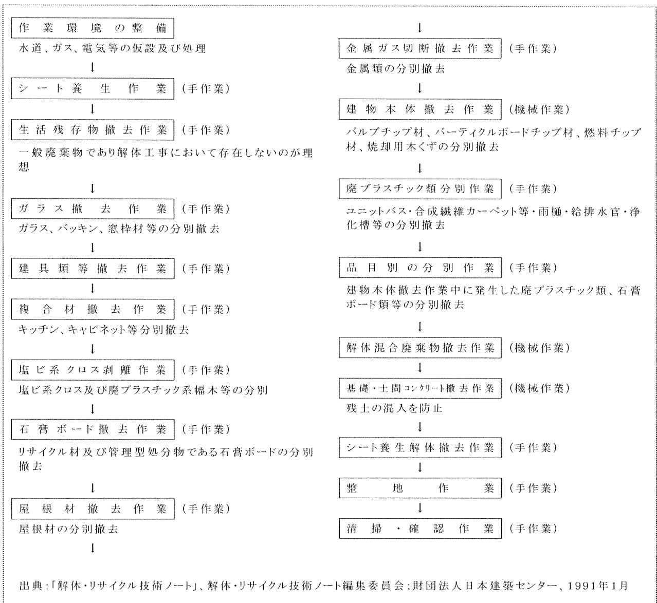
図1-5 木造住宅の解体の流れ
