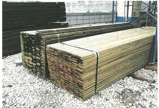
写真-7 外壁下地材もCCA処理
