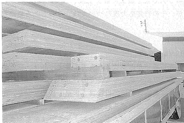
図3-22. 二次接着された後、端部の加工を施され出荷を待つ構造用LVL
