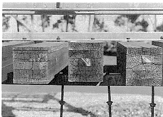
図4-8. 屋外暴露による集成材の割れ(左から、LVLを外層に用いた複合スギ集成材、スギ集成材、カラマツを外層に用いた複合スギ集成材)。暴露5年後。
