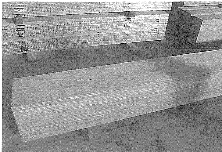
図4-31. 二次接着されて大断面になったスギ構造用LVL
