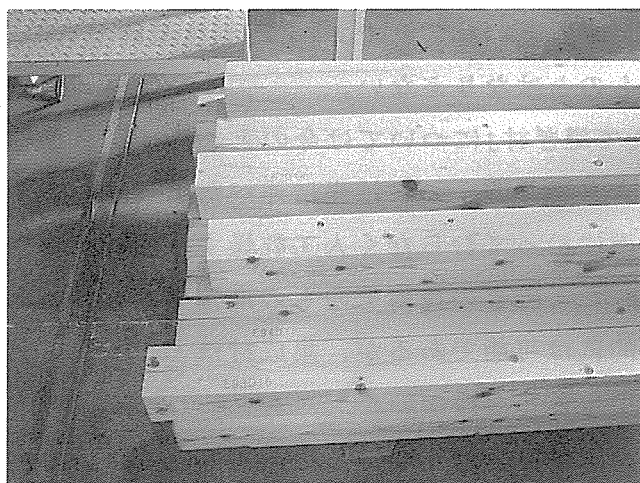
図4-21. 性能表示されたスギ正角材
