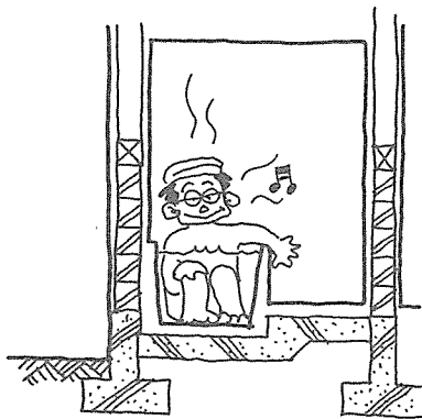
図 布基礎の上にコンクリートブロックを積み上げて腰壁とした部分
