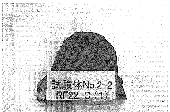
写真52 RF22-C(1) 炭化状況
