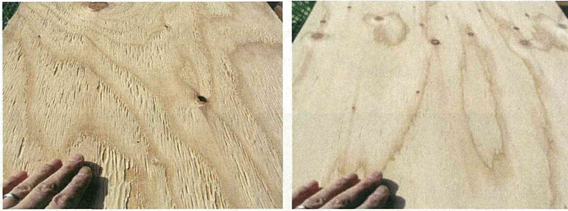
写真-7 表面の状況 (左:うら「粗い面」・右:おもて「平滑面」)
