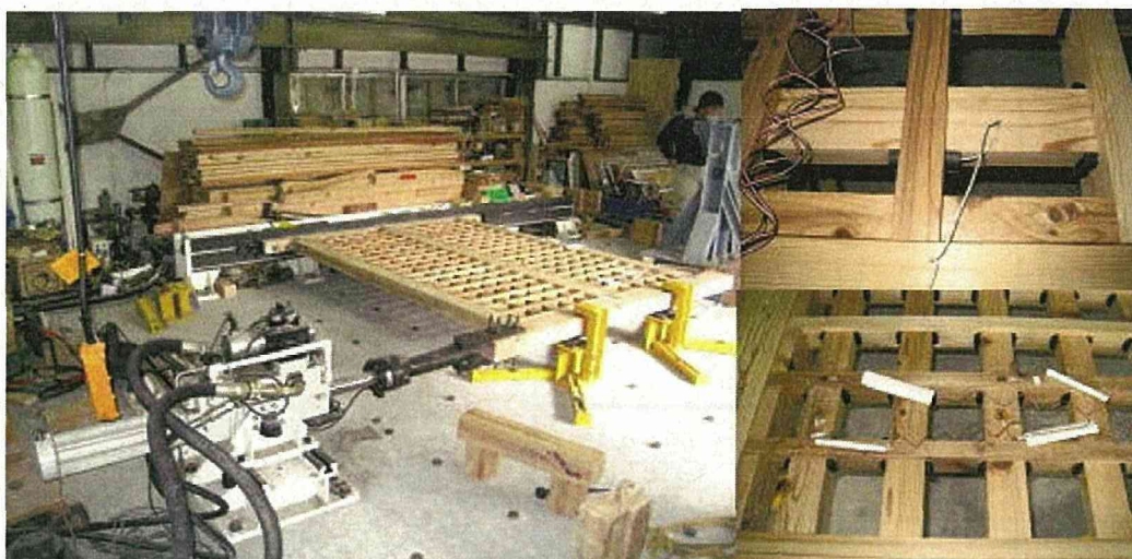
図-10 格子パネル真壁耐力壁の動的繰返し加力試験
