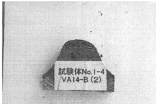
写真51 VA14-B(2) 炭化状況
