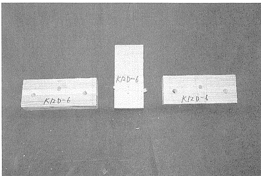
写真2-21 K12D-6 木栓が両方とも、折れてしまったタイプであることがわかる。 2-2
