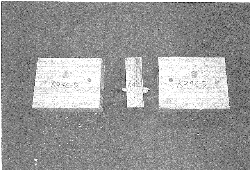
写真 2 - 101 K 2 4 C - 5 木栓が両方とも、折れ てしまったタイプであ ることがわかる。 2 - 2
