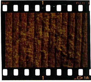
S 試験片 促進耐候性試験0時間 かびが発生した部分 倍率×20
