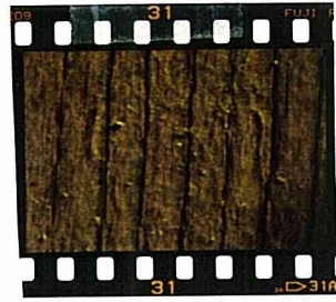
I試験片 促進耐候性試験1000時間 かびの発生した部分 倍率×20
