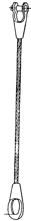
図 3.1-10 ワイヤー ・アイエンド（下端）では工場でデンデンボルトを取り付けておく ・フォークエンド（上端）では現場で取り付け可能
