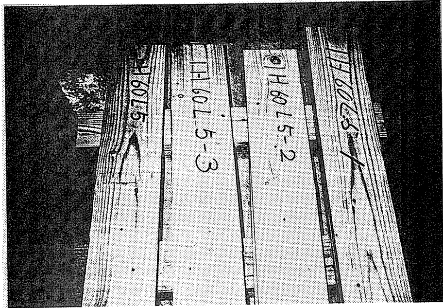
写真一 1 FJラミナ、通シラミナの破壊例（水平方向）
