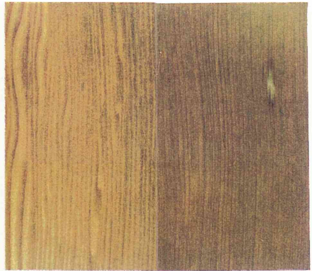
写真2-24 B: 促進耐候試験前後の外観比較
