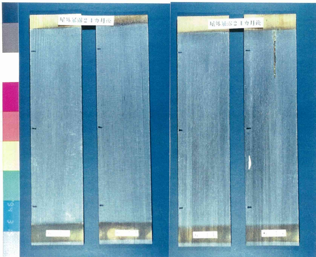
図 8 - 6 屋外暴露 24 ヶ月後のアミニ油系含浸クリヤータイプ (F)
