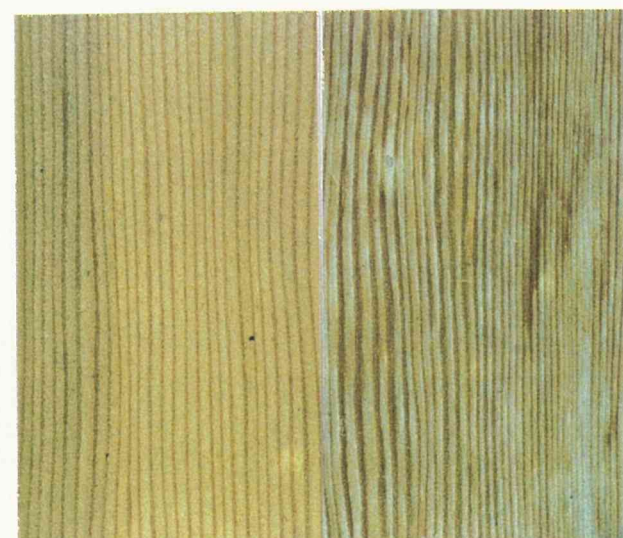
写真2-28 F: 促進耐候試験前後の外観比較
