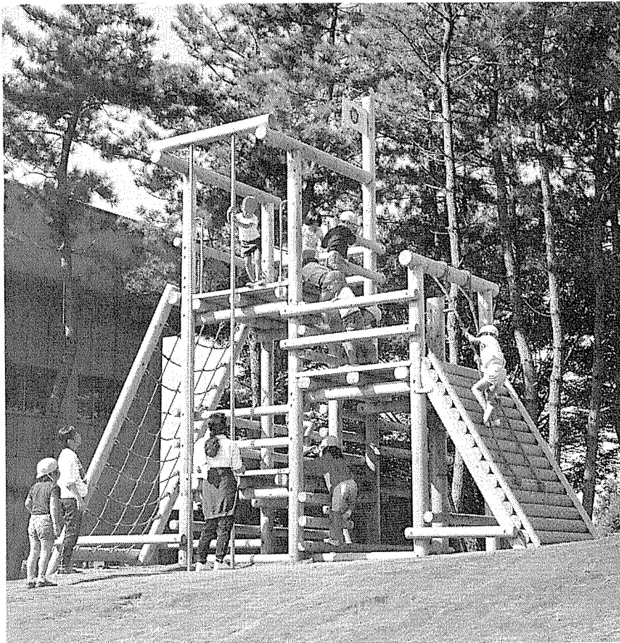
写真3 スギ丸棒加工材を使った最近の木製コンビネーション遊具
