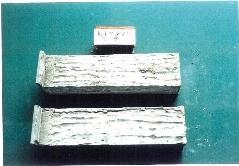
写真 5 - 8 硬化不良を生じたモルタル片 (北洋カラマツ生板)
