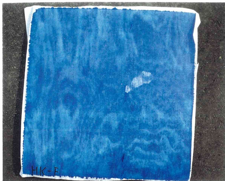
写真5-1 不織布の浮き上がりのある表面処理合板
