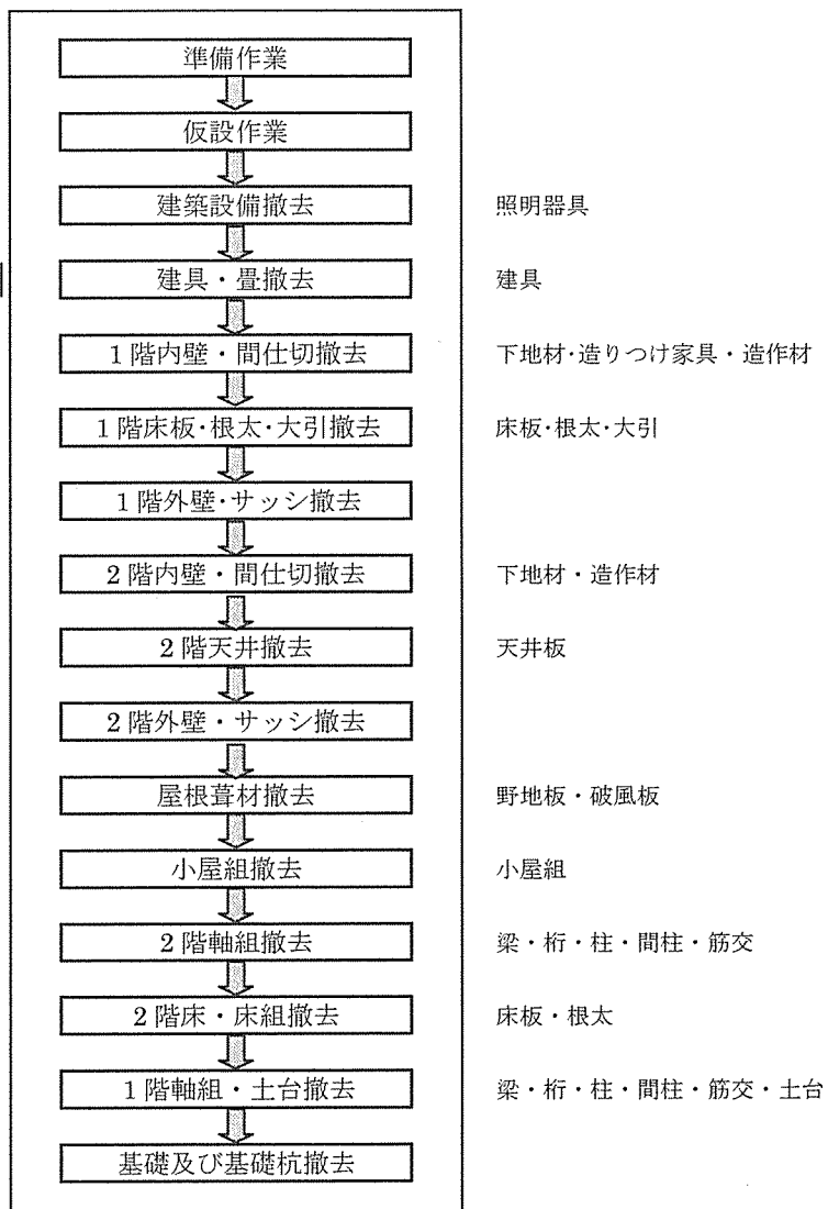
図 4.1 手作業解体工事の手順と採取できる解体木材
