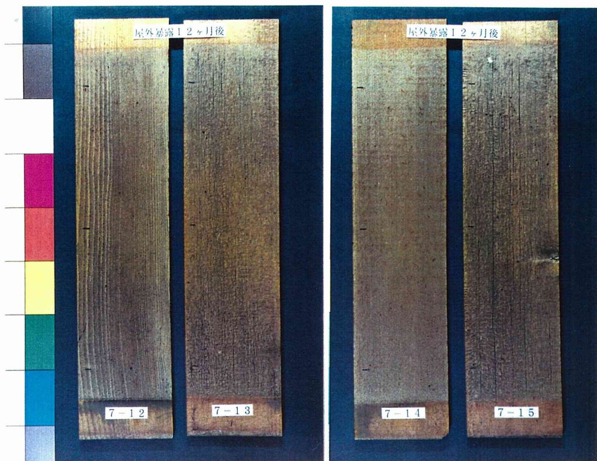
図15-7 屋外暴露12ヶ月後のアルキド系含浸着色タイプ(G)
