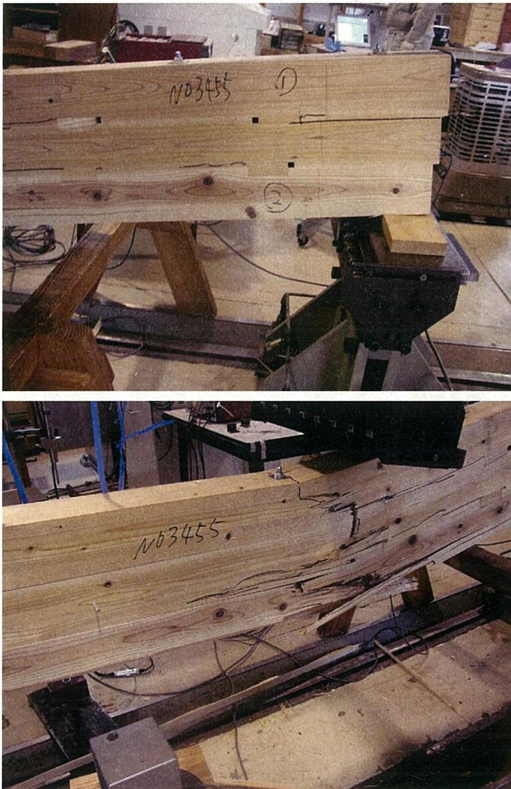
写真 3.3-20 両端せん断破壊の後曲げ破壊 (NO. 345)
