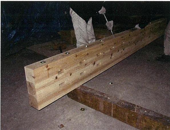
写真 2.2-16 ボルトの挿入
