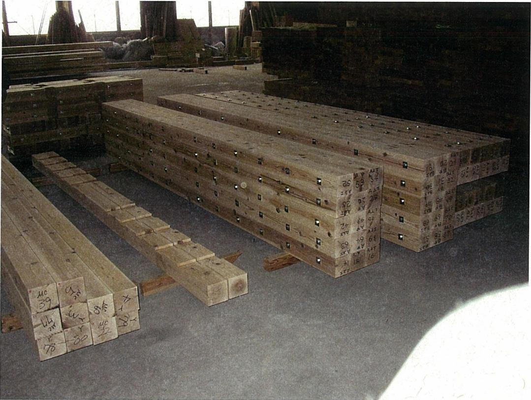
写真 2.2-24 完成したシャチ・ボルト接合重ね梁
