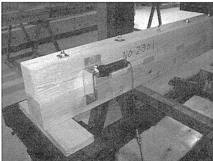
写真 2.5-5 ツインビームの変位計 4、5 の取り付け (図 2.5-2 参照)
