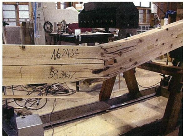
写真 3.3-9 両サイドでせん断の後ボルト位置で曲げ破壊、上部座屈 (NO. 2454)
