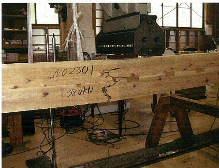
写真 3.3-1 ボルト位置での単純曲げ破壊 (NO. 2301)
