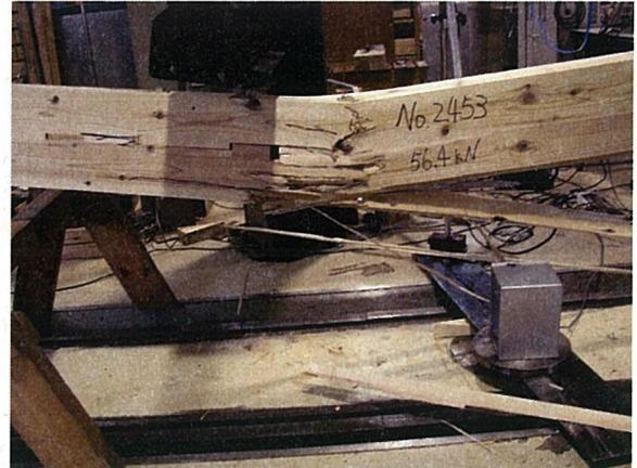
写真 3.3-8 両サイドでせん断の後ボルト位置で曲げ破壊、上部座屈 (NO. 2453)
