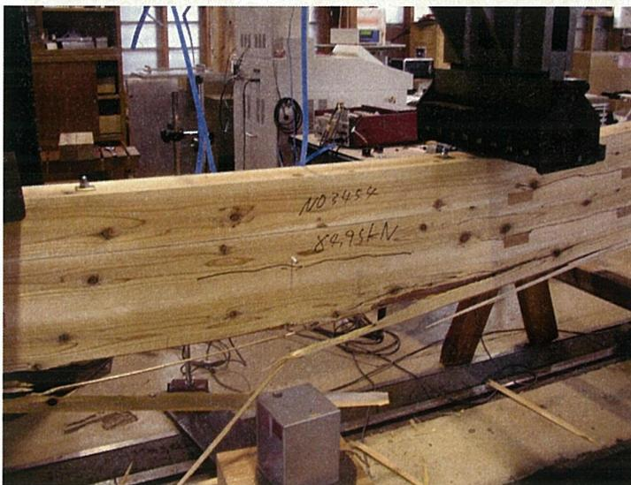
写真 3.3-19 両端せん断破壊の後曲げ破壊 (NO. 3454)
