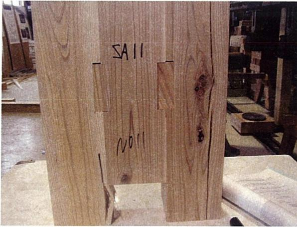
写真 3.2-1 側材左側のせん断破壊が
