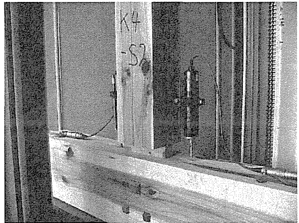
写真2-30 変形状況 込み栓の曲げとほぞのせん断
