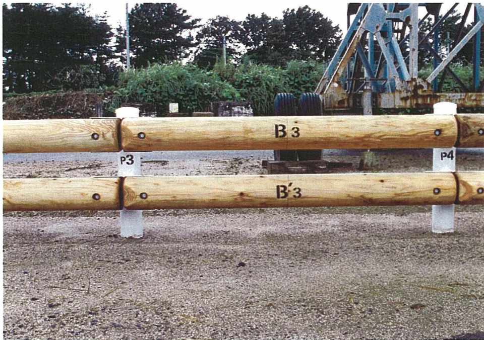
写真 2 - 5 衝突前の防護柵
