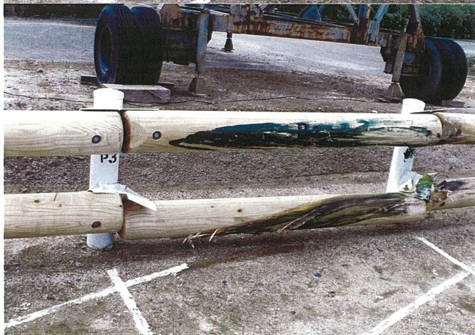
写真 2 - 7 衝突後の防護柵 (2)
