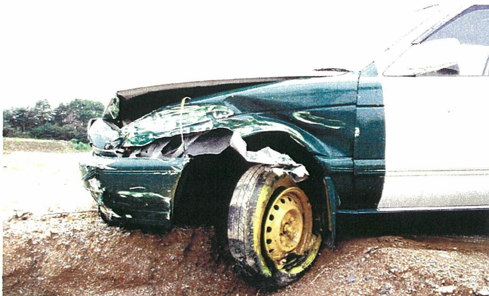
写真 2 - 8 車両の損傷状況 (1)
