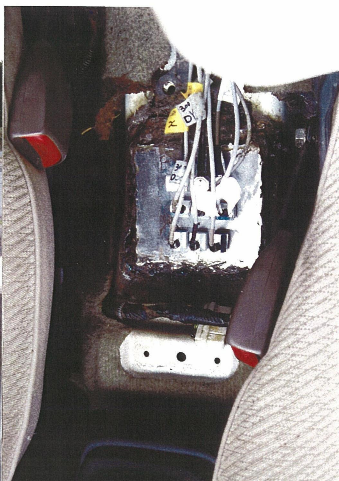
写真 2-2 乗用車に取り付けられた加速度測定センサー
